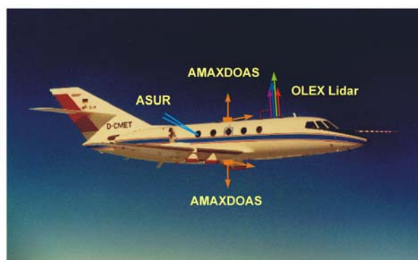
Abbildung 1: Die DLR-Falcon und die Blickrichtungen der Instrumente während der SCIA-VALUE Kampagnen
